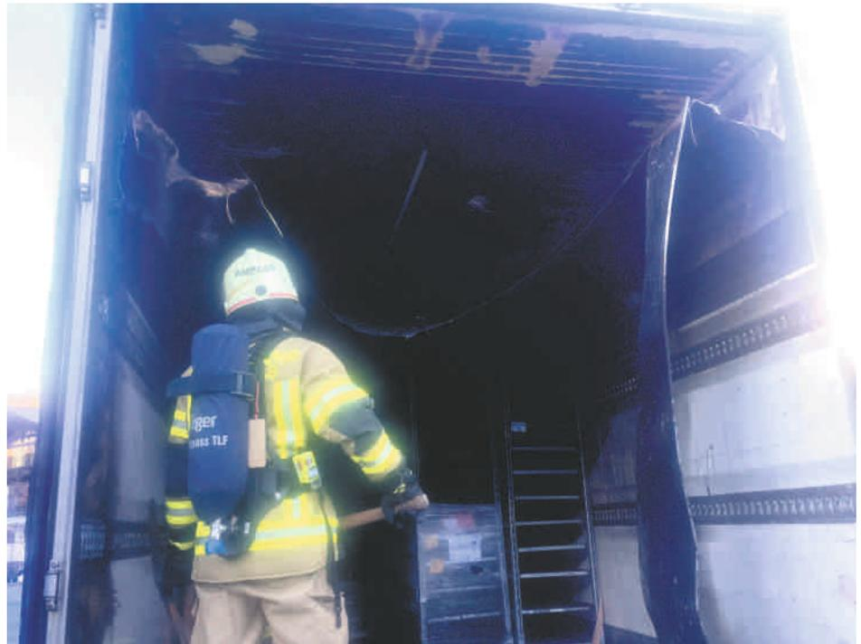
**M**it dem Alarmtext „LKW Brand Raststätte Rosenberger“ wurden wir am 14.02. um 09:13 Uhr alarmiert! Bei einem LKW beladen mit Blumen war die Zusatzheizung im Aufbau in Brand geraten.
